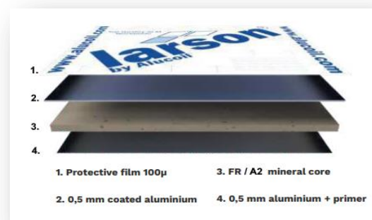
Imagen 3: Panel composite aluminio larson®FR y larson®A2. Fuente: Alucoil, S.A.
